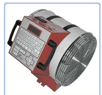
Naprava za merjenje zrakotesnosti Blowtest 3000 z vgrajenim procesorjem izvedbe predpisanih meritev
